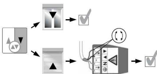
Prüfen Sie die Drehrichtung durch kurzes drücken der AB-Taste.
